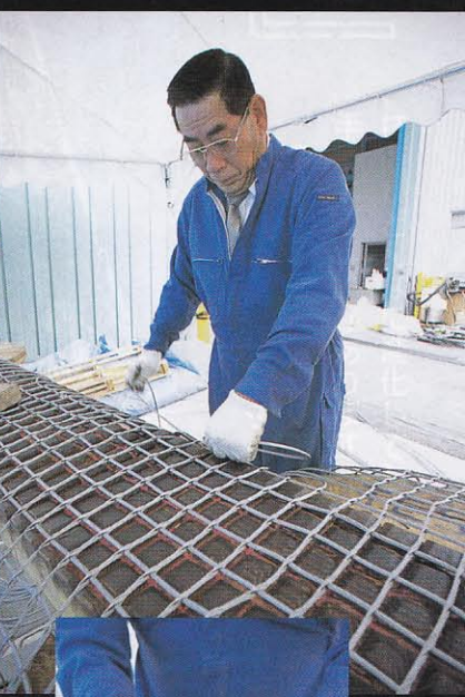
↓この日は、製鉄所の溶鉱炉の改修に使うワイヤネットを製作中。「最も危険を伴う作業に、わが社の製品を選んでいただけるのだからいつも感謝しています」。安全性に妥協を許さず、信頼を裏切らない努力が続きます。
