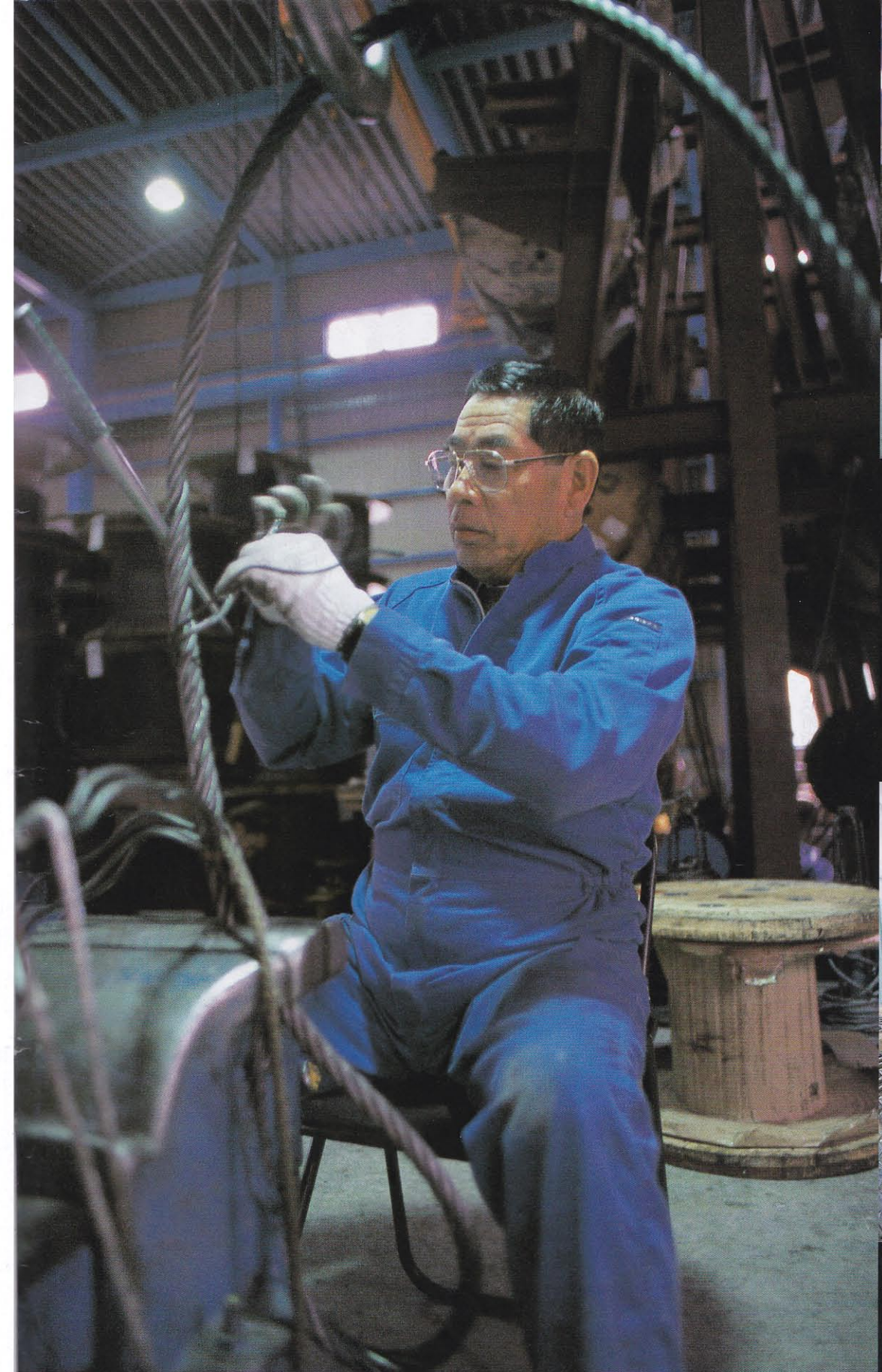
↓この日は、製鉄所の溶鉱炉の改修に使うワイヤネットを製作中。「最も危険を伴う作業に、わが社の製品を選んでいただけるのだからいつも感謝しています」。安全性に妥協を許さず、信頼を裏切らない努力が続きます。
